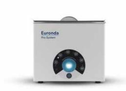
**Das Eurosonic® 3D** reinigt gründlich mit der vielfach bewährten Sweep-Mode-Technologie. Mittels digitaler Steuerung werden permanente Frequenzwechsel erzeugt. Dadurch wird eine besonders gründliche und schnelle Reinigung erzielt. Die zentrale Controller-LED unterstützt das E-Light Lichtsystem. Es stehen Zykluszeiten bis 30 Minuten bei konstant 60 °C zur Verfügung.
